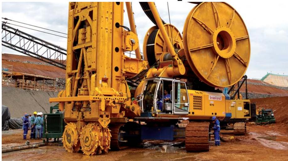
Bauer Schlitzwandfräsen ermöglichen den Bau von Schlitzwänden selbst bei schwierigen Bodenverhältnissen und extremen klimatischen Bedingungen.
