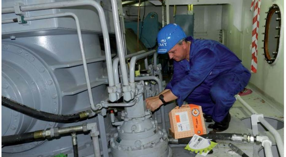
*Entnahme einer repräsentativen Ölprobe aus dem Triebwerk eines Schiffsmotors*
