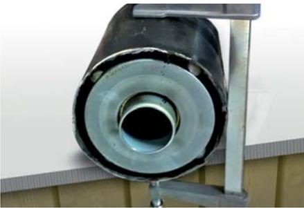
2. Fixieren Sie das metallische Filtergehäuse (nur, wenn der Filter in ein Metallgehäuse eingebaut ist). Öffnen Sie zunächst das Gehäuse am Bördelrand. Trennen Sie den Blechmantel mittels eines Winkelschleifers oder einer Eisensäge auf. Vermeiden Sie dabei eine Kontamination des Filtermaterials.
