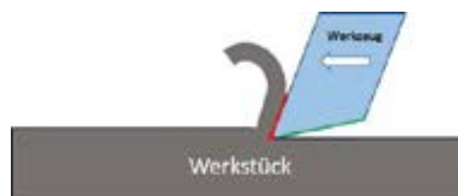
Bild 2: Prinzip des Spanens mit geometrisch bestimmter Schneide (© OilDoc)
