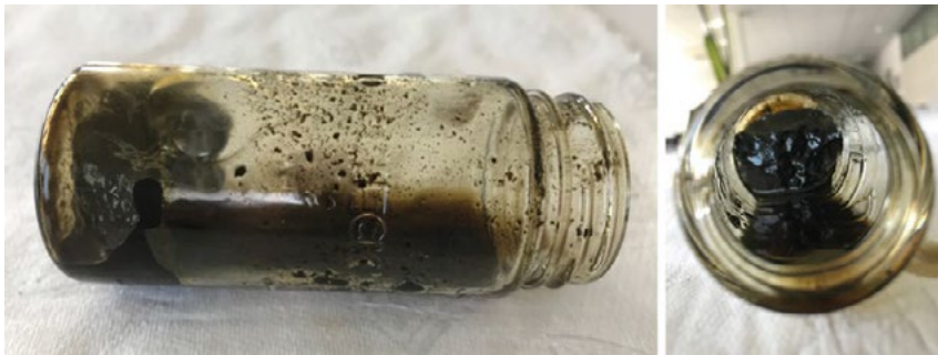
Abb. 2: Polymerisierte Ablagerungen durch Ver- mischung (OilDoc GmbH)
