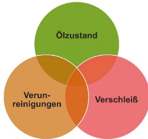
**Abb. 6:** Grundsätzliche Zielrichtung einer Routine-Ölüberwachung
