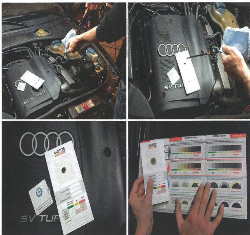
**Bild 3** Anwendung von MOTORcheckUP: Schutzblatt entfernen, Ölkontrollstab herausziehen, nur einen Tropfen Öl auf das Testblatt fallen lassen, das Ergebnis reifen lassen und mithilfe der Tabelle auswerten
