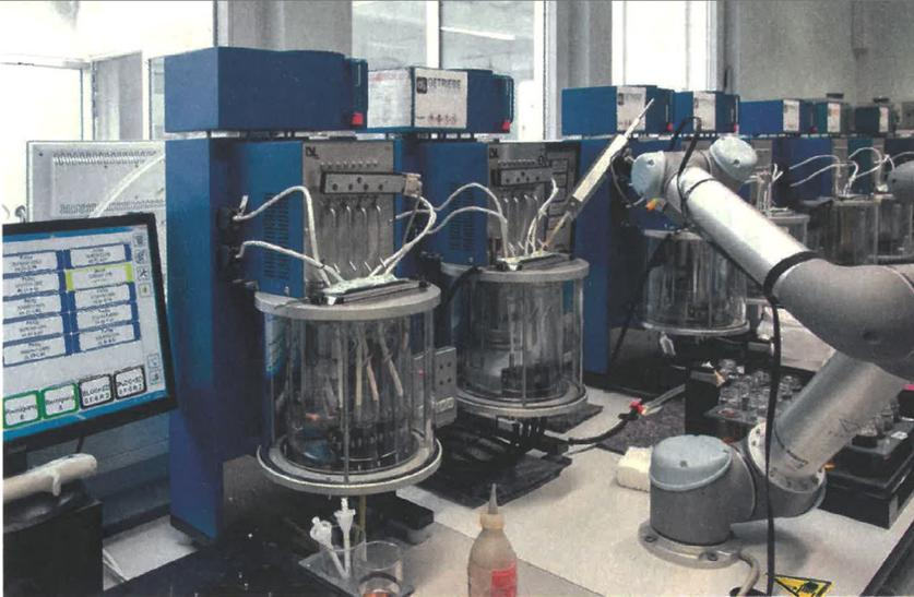
**Bild 2** Laborgeräte zur Bestimmung der Viskosität
