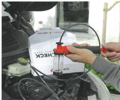
**Bild 3** Das Motoröl wird über das Rohr des Ölpeilstabes bei betriebswarmem Motor abgezogen. Hier mit einer professionellen Unterdruckpumpe. Eine einfache Einwegspritze tut's aber auch
