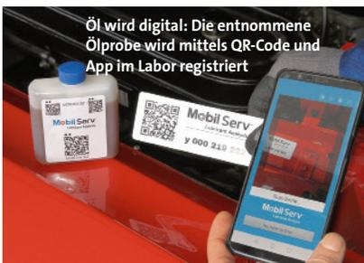
Öl wird digital: Die entnommene Ölprobe wird mittels QR-Code und App im Labor registriert
