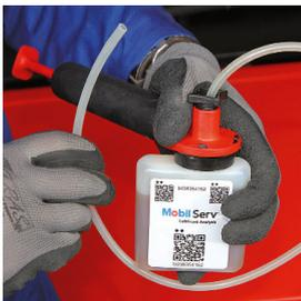
Das Zubehör: Eine kleine Vakuumpumpe fördert die Ölprobe durch das Peilstabrohr direkt in den Versandbehälter
