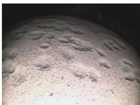
Die Kolbenkronen, hier Zylinder 1, tragen erhebliche Ascheablagerungen
