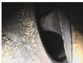
Bereich des Ventilsitzes in Zylinder 2: Ölkruete und Ascheablagerungen
