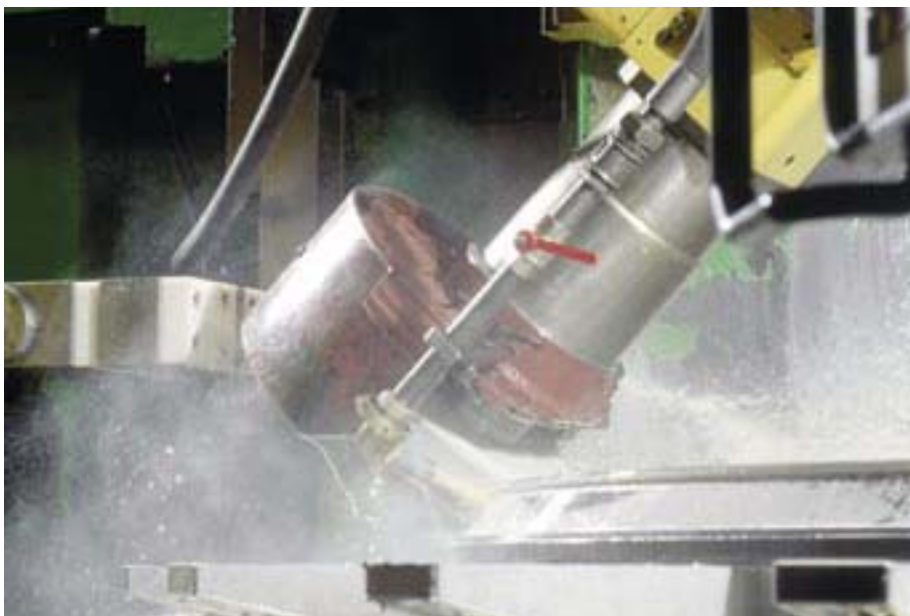
Hochgeschwindigkeits-Schleifen mit transparenter Schleifemulsion
