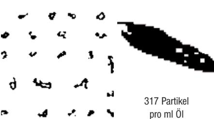
Unter Belastung reagieren Ölzusätze und bilden langkettige chemische Verbindungen, die als sogenannte „Tribopolymere“ als längliche, teilweise durchscheinende Partikel abgebildet werden. Diese weichen Partikel, die durch Wirkstoffe entstanden sind, stören im langsamlaufenden Getriebe nicht, sondern fördern oft noch die Ausbildung eines optimalen Schmierfilms. Im Vergleich mit den Verschleißpartikeln ist dieser Anteil unerwartet niedrig.
