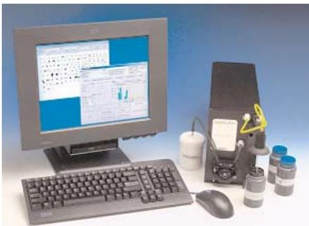
Besonders bei langsamlaufenden Planetengetrieben (Ölumlauflagen, Großmotoren, komplexen Hydrauliksystemen, ölgeschmierten Anlagen), deren Überwachung mit Vibrations- oder anderen Sensoren Probleme bereitet, liefert die O.P.A. wesentliche Informationen über den Verschleißzustand und dessen Ursache.
