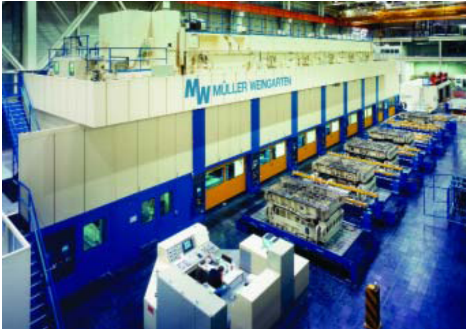
Müller-Weingarten Transferpresse in der Automobilindustrie. In solchen Maschinen für die spanlose Umformung hat sich der Brugger-Test bewährt
