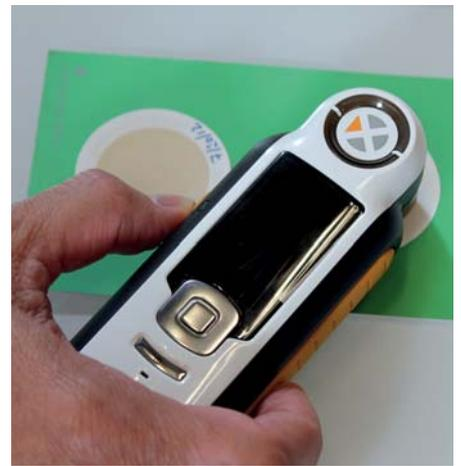
MPC-Test – Filterauswertung mit dem Colorimeter
