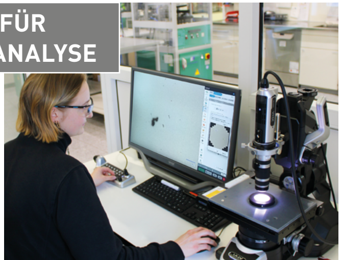
Das neue Keyence VHX-X1F im Einsatz: Chemielaborantin Genoveva Hahl bei der mikroskopischen Analyse
