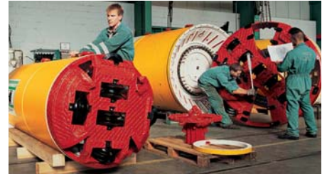
Montage von Microtunnelling-Maschinen
