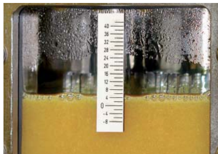
Schäumendes Öl in der Prüfvorrichtung
