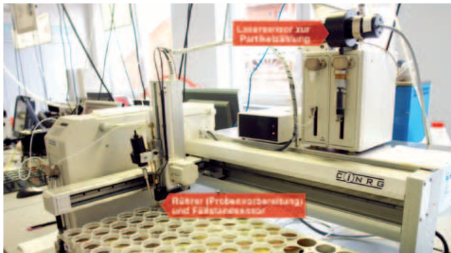
Der innovative Partikelzähler im OELCHECK-Labor bietet entscheidende Vorteile.
