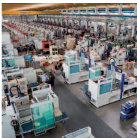
In Diethenhofen produzieren 443 Spritzgießmaschinen täglich bis zu 10 Millionen Einzelteile.
