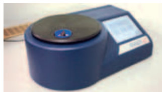
Bestimmung des PQ-Index
