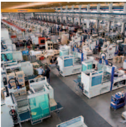
In Dietenhofen produzieren 443 Spritzgießmaschinen täglich bis zu 10 Millionen Einzelteile.
