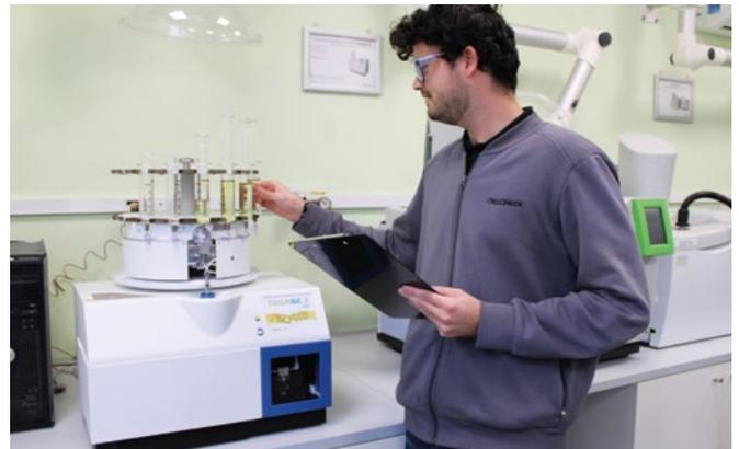
Nach dem Eintreffen einer Probe im Labor entnehmen die OELCHECK Laboranten mit einer Glasspritze 50 ml direkt aus der Probenflasche. Diese wird auf dem Autosampler des neuen Geräts platziert und die Gas-in-Öl-Analyse startet.
