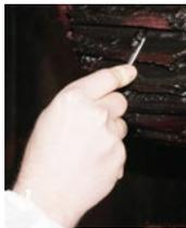
Sollen aus Systemen regelmäßig Ölproben entnommen werden, empfiehlt sich der permanente Einbau einer Entnahmestelle. Darauf spezialisierte Lieferanten bieten eine ganze Reihe unterschiedlicher Lösungen für druckbeaufschlagte und drucklose Ölsysteme.
