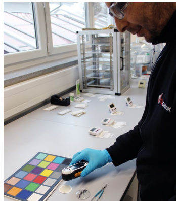
Fluitem MPC Color für die Ermittlung des MPC-Index
