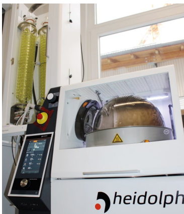
Heidolph Hei-Vap Rotationsverdampfer (mit Hei-Volyme Distimatic Pro Automatisierung) zur Heptanrückgewinnung
