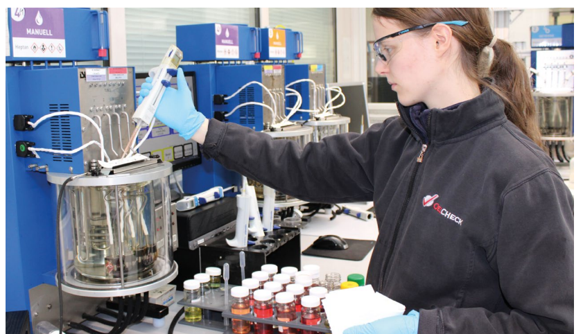
Zwei neue ISL Houillon VH-1 Bäder für die manuelle Viskositätsbestimmung
