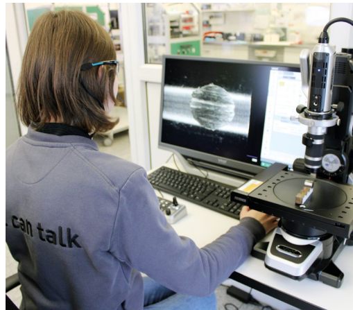
Keyence VHX-S660E Mikroskop zur Vermessung der Verschleißmarken von Brugger- und VKA-Test
