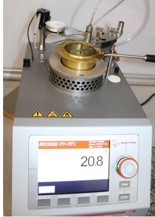
Anton Paar PMA 300 FPC und Anton Paar CLA 5 FPO zur Flammpunktbestimmung
