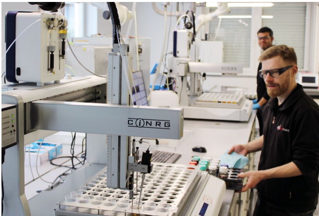
Zwei zusätzlich CINTRG APC3 Particle Counter zur Ermittlung von Partikelzahlen und -größen sowie Reinheitsklasse nach ISO 4406
