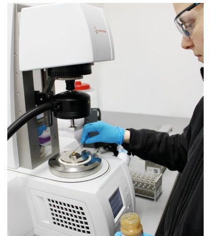
Anton Paar Rheometer MCR 102e zur Bestimmung der Scherviskosität von Schmierfetten
