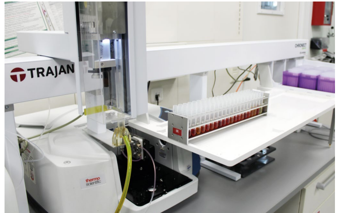
Zusätzliches Thermo Scientific Nicolet Apex und CTC Analytics PAL RTC Autosampler für die IR-Spektroskopie
