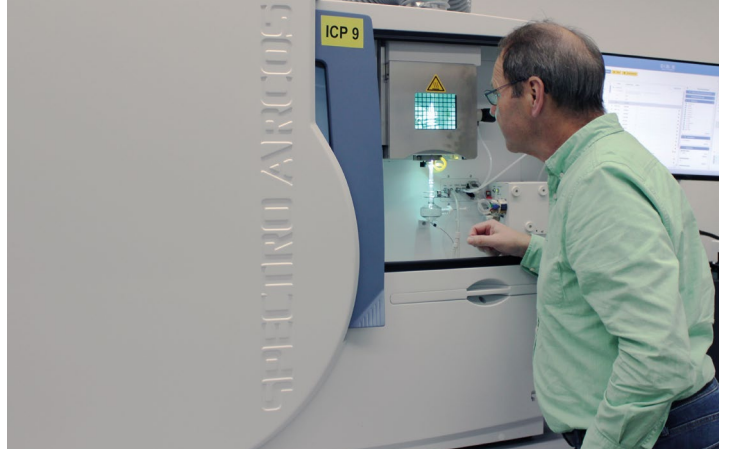
Unser siebtes Spectro Arcos ICP-OES für die Elementbestimmung
