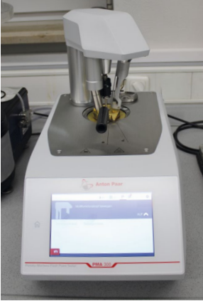
Anton Paar PMA 300 FPC und Anton Paar CLA 5 FPO zur Flammpunktbestimmung
