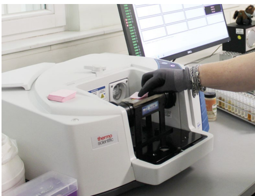
Thermo Scientific Nicolet APEX IR mit HATR-Zelle für die IR-Spektroskopie von Schmierfetten
